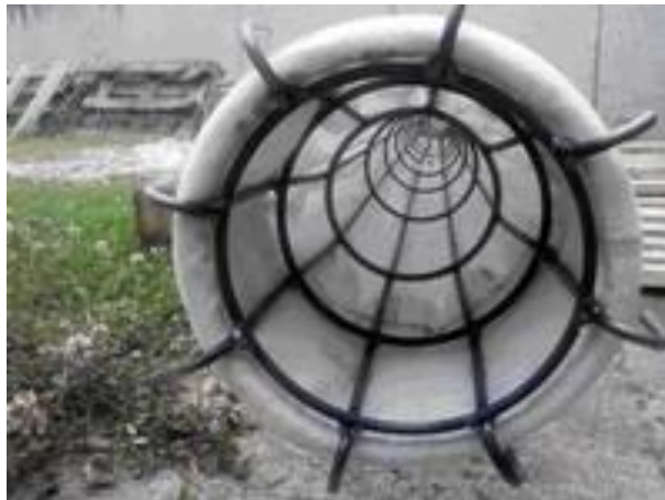
Fig. 5. 3DESA filtrpatron for zinc dust
